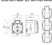
Schéma 1 MB 27/30 Dim. en mm
